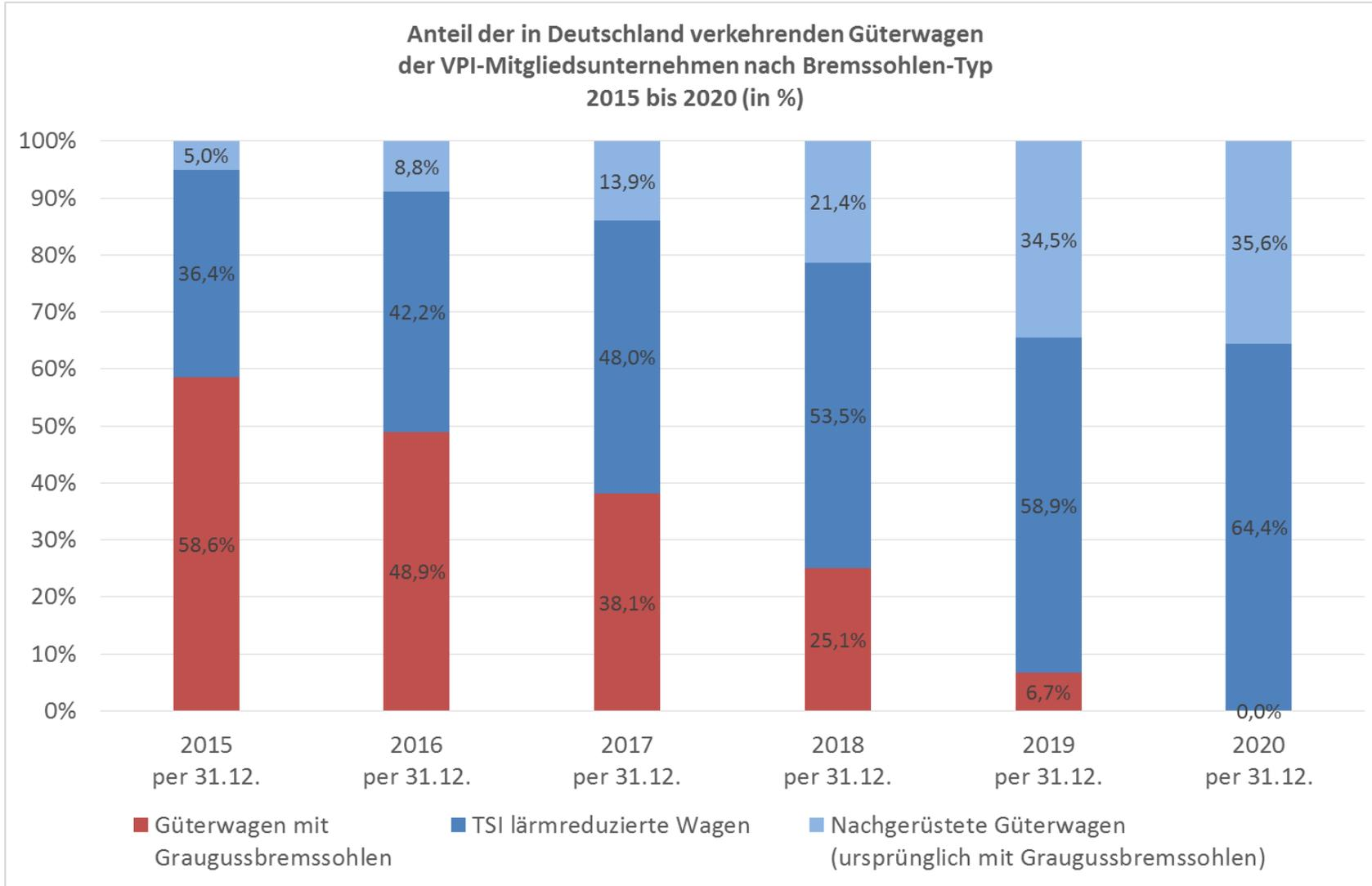
**Bis ins Jahr 2020 werden vsl. ca. 21.000 Güterwagen, die ursprünglich mit Grauguss-Bremssohlen ausgestattet waren, nachgerüstet.**
